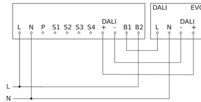
Schéma du circuit principal avec lampe commutée
